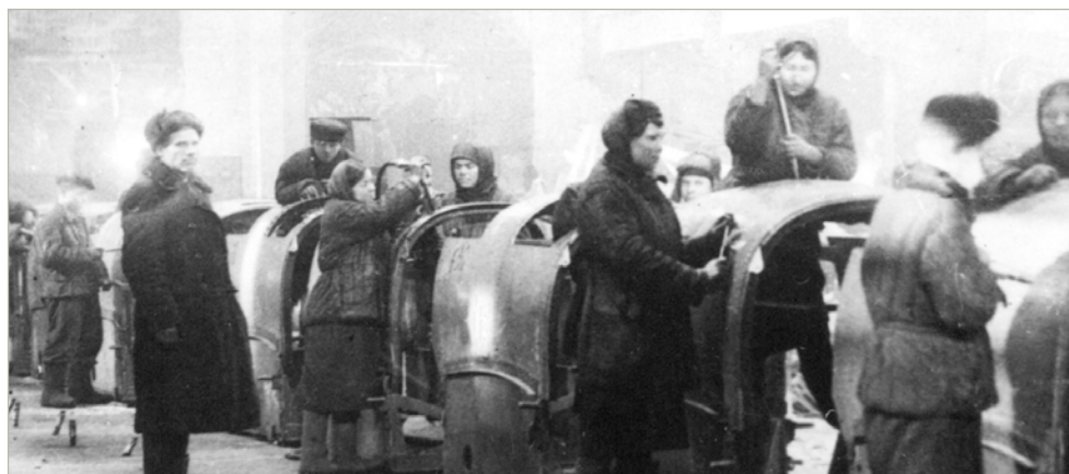
► Поточно-конвейерная сборка бронекабин для легендарного самолета-штурмовика Ил-2 на Куйбышевском механическом заводе №207, 1943 год
